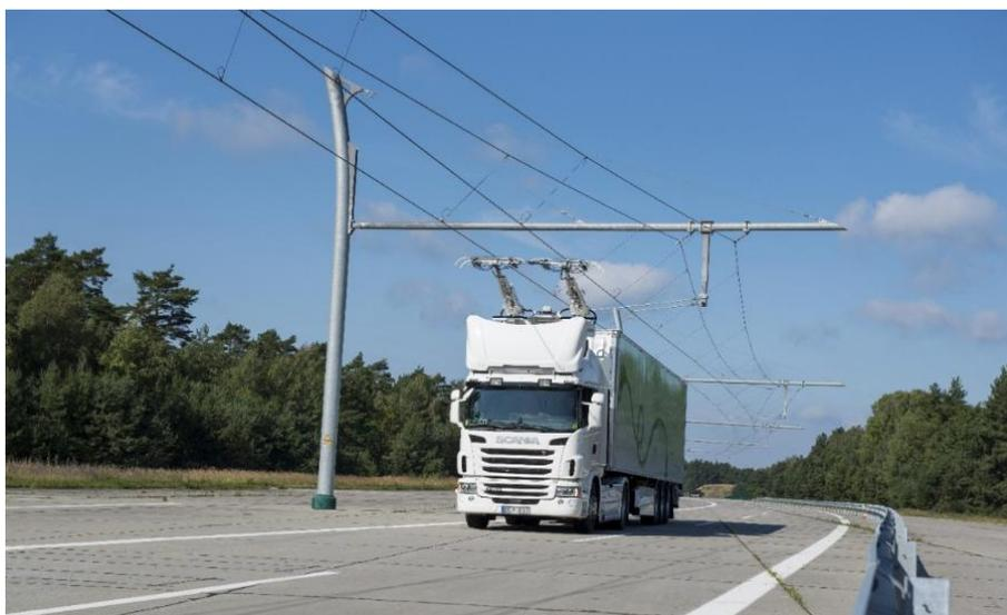
Parmi les différentes technologies possibles de captage dynamique de l'électricité, la caténaire est celle retenue par Scania pour ses expérimentations. Un pantographe fixé
