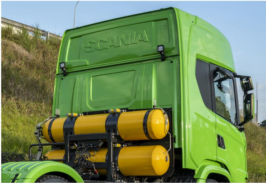
D – Exemplo de veículo com tanques atrás da cabine (235 litros)
