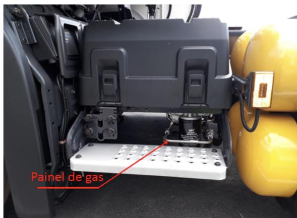
Figura 22: Detalhe da localização do painel de gás sob a caixa de baterias, comum para os veículos
