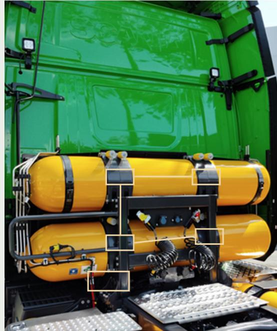
Figura 25: Posição das marcações dos conjunto de suporte dos cilindros atrás da cabine.
