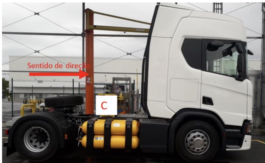
**C** – Exemplo cilindros de 95 litros posicionados no lado direito do veículo.
