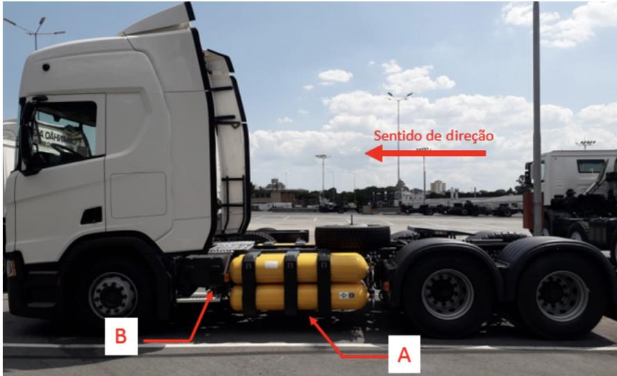
**A** – Exemplo cilindros de 118 litros posicionados no lado esquerdo do veículo.
