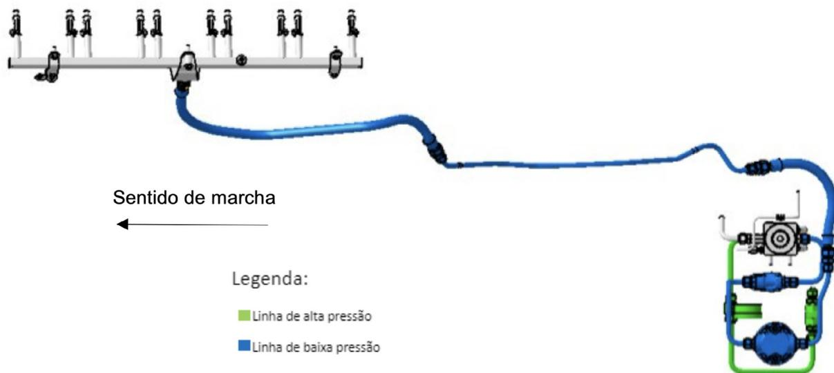
Figura 9: Arquitetura da tubulação de baixa pressão
