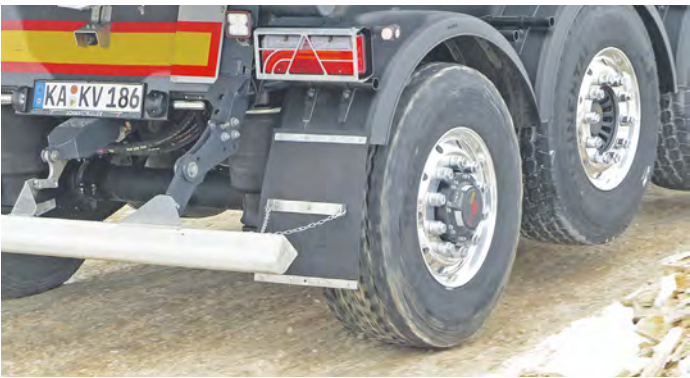
Vier Tonnen Aufstandsdruck bei Leerfahrt reichen: Wenn die Trailer-achse eingreift, fliegen die Steinchen und es geht vorwärts.
