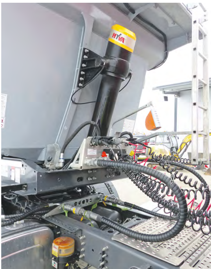
Gut erreichbares Anschlusspanel, dank Rollplane und Laderaum-Kamera kann eine leichte Alu-Leiter die schwere Arbeitsplattform ersetzen.
