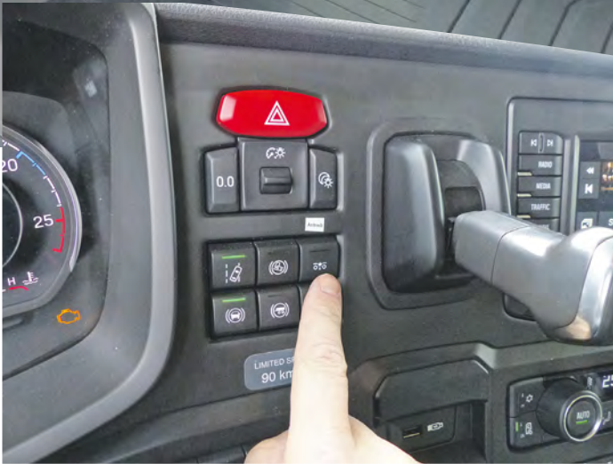
Aktivieren ist einfach: Nur Taster drücken und schon treibt die letzte Trailerachse mit an.
