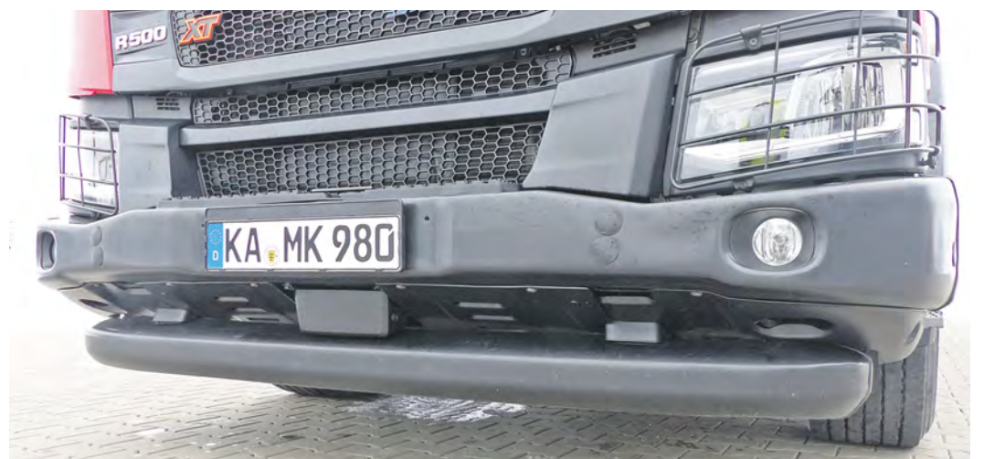
Der vordere Rammschutz kennzeichnet die XT-Reihe, schränkt aber auch den Böschungswinkel ein.
