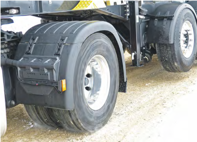
Ohne Trak-Unterstützung vom Trailer drehen rückwärts bergauf die Antriebsräder trotz Sperre durch.
