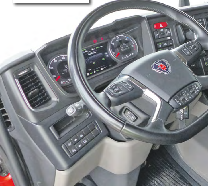
Das große Armaturenbrett bietet einen trefflichen Arbeitsplatz mit hohem Komfort und Funktionalität. Die 16 cm hohe Motorkiste ist eine Folge der tief aufgesetzten Kabine, stört aber kaum.
