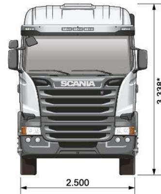
*\*\*Pode variar dependendo da altura do pneu e altura do chassis*
